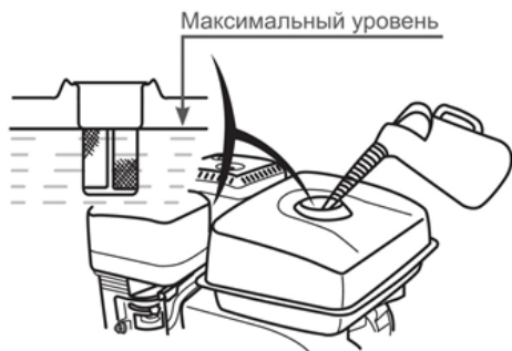
Рис. 6 Максимальный уровень топлива в топливном баке
