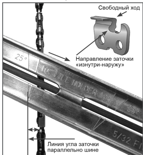
Рис. 24 Расположение линии угла заточки
